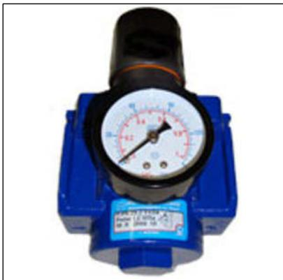
Редуционные пневмоклапаны «П-РК» с условным проходом (Ду)4;6;10;16;25мм с ручной настройкой давления на выходе, пружинной нагрузкой, с мембранным чувствительным элементом и стабилизированным дроссельным клапаном предназначены для понижения давления сжатого воздуха и поддержания его на заданном уровне в пневматических приводах различного назначения.
