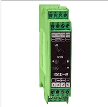
Блоки управления ВМД-20DIN и ВМД-40DIN разработаны для управления работой коллекторных двигателей постоянного тока с напряжением питания до 24 В. Блок управляет скоростью и направлением вращения мотор-редуктора постоянного тока.
