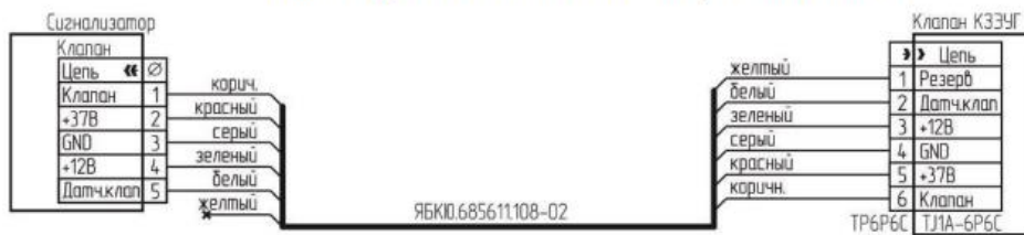
Схема подключения клапана КЗЭУТ с разъемом TJ1A-6P6C
