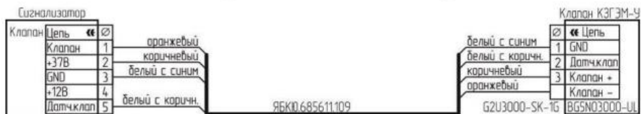
Схема подключения клапана КЗГЭМ-У с разъемом BG5NO3000-UL.
