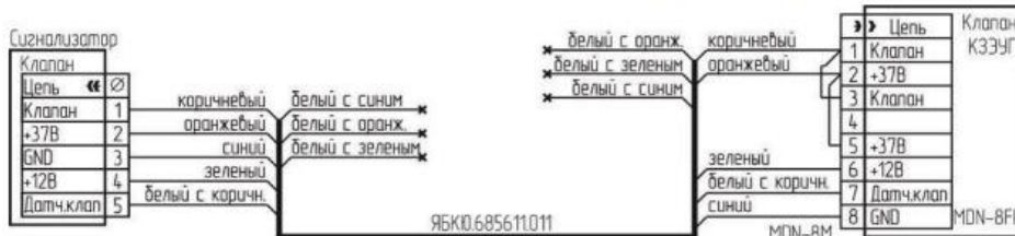
Схема подключения клапана КЗЭУТ с разъемом MDN8FR.
