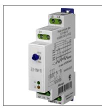
Реле контроля трехфазного напряжения **ЕЛ** предназначено для контроля наличия (обрыва), «слипания», порядка чередования фаз в цепях трехфазного напряжения с изолированной нейтралью, а также для контроля асимметрии, снижения-превышения напряжения
