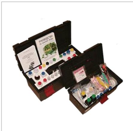
Лаборатория НКВ-2Ф предназначена для определения основных показателей качества воды в лабораторных и полевых условиях.
