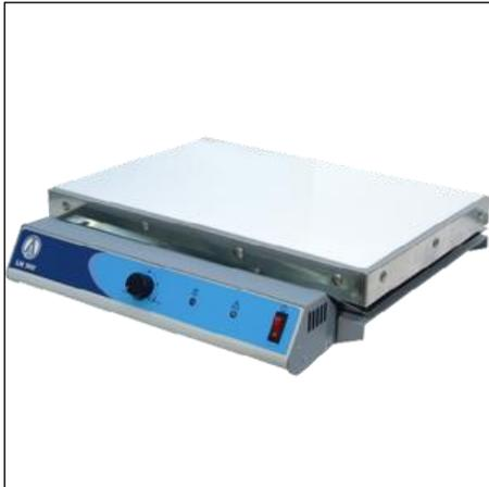
Нагревательная плита LOIP LH-302 с рабочей поверхностью из стеклокерамики предназначена для безопасного нагрева одновременно нескольких проб в одинаковых условиях. Благодаря высокой химической стойкости материала рабочей поверхности, прибор можно применять для нагрева самых агрессивных реагентов (концентрированных кислот и щелочей) без риска коррозии нагревательной поверхности.
