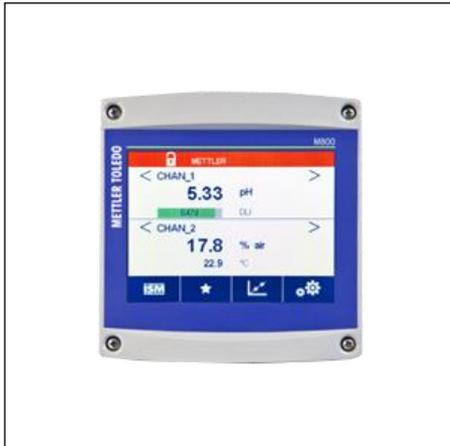
Транзиттер M800 выпускается в 1-, 2- и 4-канальной модификации и обеспечивает одновременную работу датчиков для измерения рН/ОВП, растворенного или газообразного кислорода (как оптическим, так и амперометрическим методом), растворенного озона, электропроводности и мутности.
