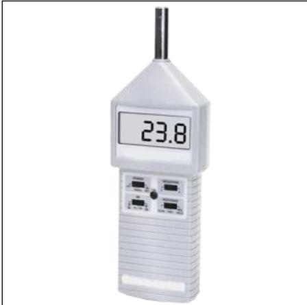
Недорогой портативный интегрирующий измеритель уровня звука (шумомер) АТТАКОМ АТТ-9000 имеет встроенный конденсаторный микрофон, он обеспечивает диапазон измерения звука в пределах от 30 до 130 дБ в полосе частот от 31,5 Гц до 8 кГц. Функция аналогового выхода позволяет использовать шумомер АТТАКОМ АТТ-9000 в автоматических системах экологического контроля акустических параметров производственных и жилых помещений.
