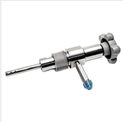
Вентиль-пробоотборник ВП1-15x14 (21, 35) предназначен для взятия проб продукта из трубопровода под давлением. Для равномерного забора проб по всему сечению трубопровода, пробоотборник снабжен пробоотборной трубкой. Пробоотборный ниппель может быть развернут относительно оси пробоотборника в любое необходимое положение и зафиксирован в данном состоянии.
