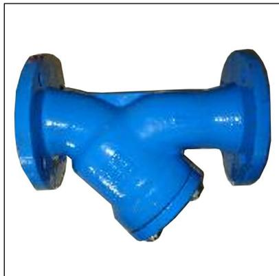
Корпус фильтра сетчатого фланцевого изготавливается из чугуна GG25, сетка – из нержавеющей стали. Фланцы по ГОСТ 12815-80 (обычные) Ру 16. Присоединительные отверстия фланцев по ГОСТ в Ру16 и Ру10 для Ду15-150 совпадают. ГОСТ-а на строительные длины на фильтры не существует.
