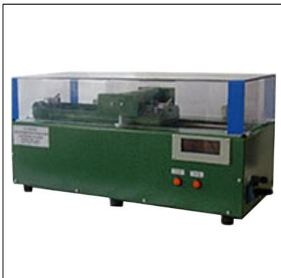
Устройство **ОПСП-01** предназначено для определения потери посыпки кровельных материалов.
