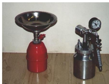
**Моечный пистолет в комплекте с баком для сбора отработанной жидкости**
