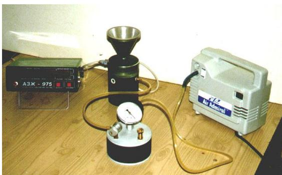
**АЗЖ-975 в комплекте с вакуумным насосом и ресивером**
