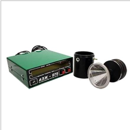
АЗЖ-975 предназначен для автоматического контроля содержания механических примесей в гидравлических, топливных и масляных системах летательных аппаратов и технологического оборудования методом отобранных проб. Обеспечивает обмен данными с внешним компьютером и дистанционное управление. Результаты анализа могут быть представлены в соответствии с требованиями стандартов ГОСТ 17216-2001, ISO 4406, NAS 1638.
