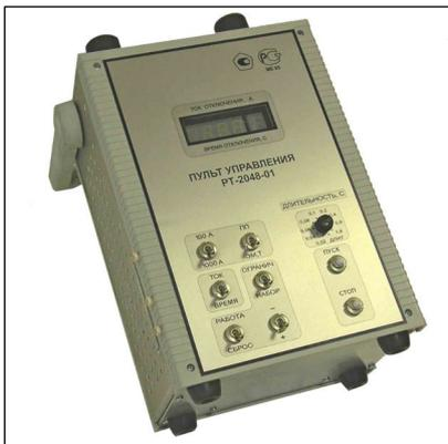
Комплект нагрузочный измерительный с регулятором тока **РТ-2048-01** предназначен для испытания АВ с номинальным током расцепителя от 4 до 80А.
