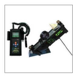
Предназначен для проверки качества магнитных индикаторов (порошков и суспензий), применяемых при магнитопорошковом методе неразрушающего контроля изделий в соответствии с ГОСТ 21105–87.
