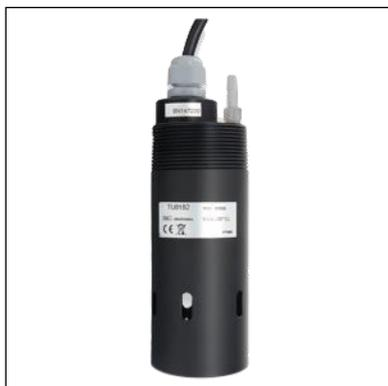
Тип датчика — погружной. Имеет встроенное устройство для очистки оптических линз сжатым воздухом. Датчик имеет встроенный преусилитель.
