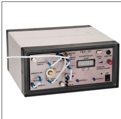
Переносной генератор аммиака **ГЕА-01** применяется в качестве рабочего эталона 2-ого разряда по ГОСТ 8.578-2008 и предназначен для приготовления увлажненных поверочных газовых смесей (ПГС) аммиака в воздухе.
