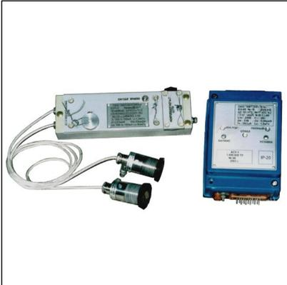
Сигнализатор уровня акустический **АСУ-1** предназначен для контроля и сигнализации наличия или отсутствия жидкости внутри емкости или трубы на уровне установки его первичных преобразователей, или момента перехода жидкости через контролируемый уровень, при этом контроль производится без контакта с жидкостью, а преобразователи сигнализатора устанавливаются на наружной поверхности контролируемой емкости без нарушения целостности ее стенок.
