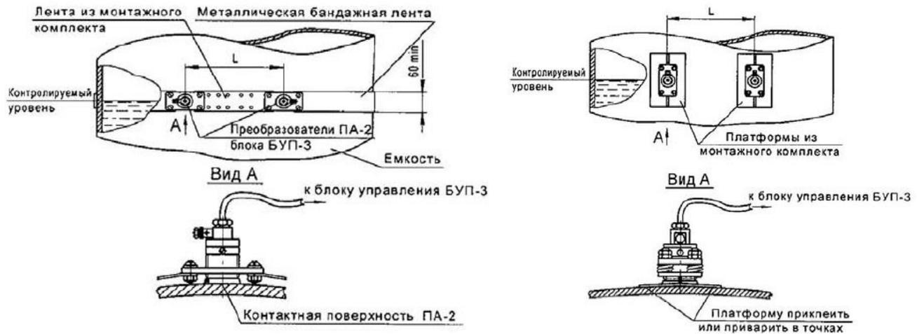
Установка преобразователей ПА-2 с помощью бандажа. Установка преобразователей ПА-2 на платформах.
