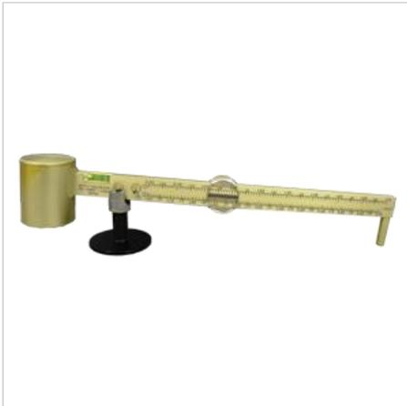
Весы рычажные-плотномер ВРП-1М предназначены для измерения плотности буровых, цементных растворов и жидких химических реагентов, имеющих температуру от + 5 до + 80°С.
