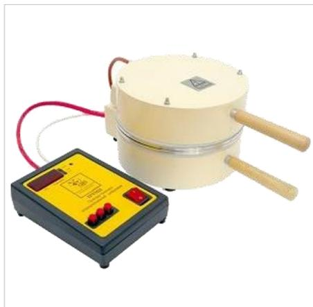
Прибор Чижова модернизированный цифровой ПЧМЦ предназначен для определения влажности образцов пищевых продуктов с автоматическим регулированием температуры плит прибора, предназначен для оперативного контроля влажности пищевого сырья, полуфабрикатов и готовой продукции.
