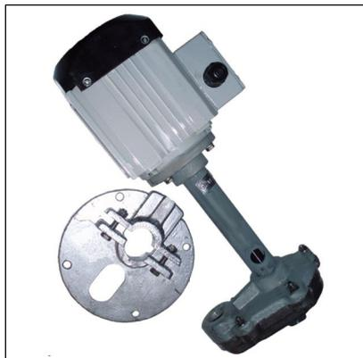
Центробежные вертикальные электронасосы типа **П** производительностью 25, 50, 125, 200 л/мин предназначены для подачи смазочно-охлаждающей жидкости к инструменту металлорежущих станков вязкостью до 90 мм<sup>2</sup>/с (сСт), не оказывающей активного коррозирующего действия на детали электронасосов, погруженных в жидкость.
