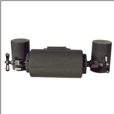
Жидкостный контейнер «КЖ 302» предназначен для хранения и транспортировки под давлением не более 30 МПа проб, отобранных из нефтяных скважин при их исследовании или проверке.
