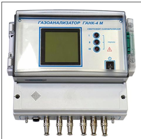
Газоанализатор ГАНК-4М является промышленным, автоматическим, непрерывно действующим прибором, в котором контролируемый газ поступает к датчику за счет диффузии или с помощью побудителя расхода воздуха. Газоанализатор предназначен для контроля и регистрации изменения концентрации загрязняющих химических веществ (ЗХВ) в воздухе рабочей зоны, в промышленных выбросах и в технологических процессах.
