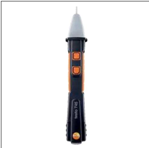
Testo-745 - бесконтактный детектор напряжения в диапазоне до 1000 В, предназначен для быстрого проведения предварительной проверки предполагаемых причин неисправности. При наличии напряжения Testo-745 подает четкий предупреждающий звуковой и визуальный сигнал.
