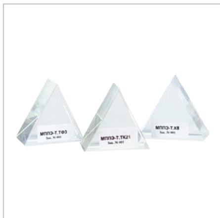
Наборы мер показателя преломления эталонные МППЭ-Т предназначены для передачи размера единицы рабочим эталонам 2-го разряда сличением при помощи компаратора (гониометра) и рабочим средствами измерений (гониометрам-спектрометрам) – методом прямых измерений в соответствии с ГОСТ 8.583-2003.
