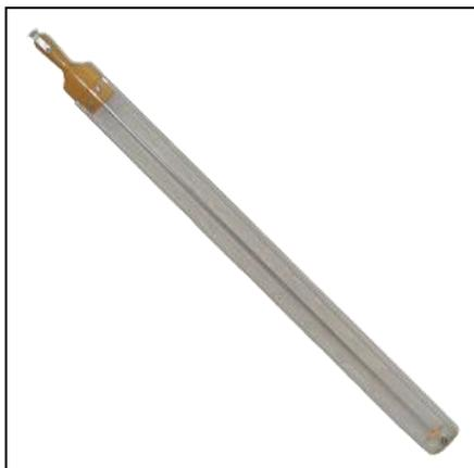
Рейка водомерная переносная с успокоителем ГР-23 предназначена для измерения высоты уровня воды в реках с быстрым течением и небольшой глубиной (до 1 м) на свайном водомерном посту.
