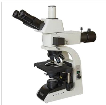
Люминисцентный микроскоп МИКМЕД-6 предназначен для наблюдения объектов в свете люминесценции при освещении от монохроматического светодиода (сверху через объектив), а также в проходящем свете.
