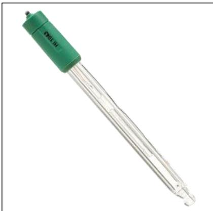
Заправляемый рН электрод со стеклянным корпусом, двойным солевым мостиком и BNC соединением. Данный электрод имеет одну керамическую диафрагму на выходе из электрода сравнения и сферическую рН-чувствительную мембрану, сделанную из термостойкого стекла.
