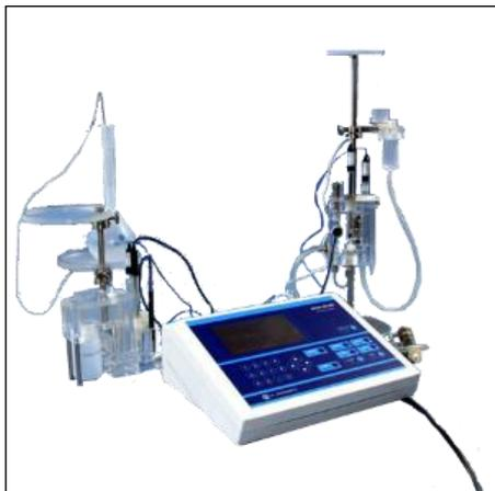
Микропроцессорный рН-метр/иономер АТОН-101МП предназначен для измерения показателя активности ионов водорода (рН), других одно- и двухвалентных ионов (рХ), а также температуры водных растворов в лабораторных условиях. Прибор позволяет отображать результат измерения в единицах концентрации (мг/л или мкг/л).
