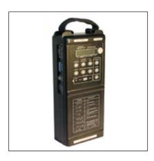
«МУЛЬТИКОР-1» - переносной анализатор, который предназначается для работы в полевых и внутризаводских (лабораторных) условиях. Данный прибор используется для проведения коррозионных измерений на металлических сооружениях, расположенных под землей. «МУЛЬТИКОР-1» объединяет в себе функции средства измерения и технологического оборудования, являясь комбинированным прибором освобождает обслуживающего оператора от рутинной и утомительной работы.
