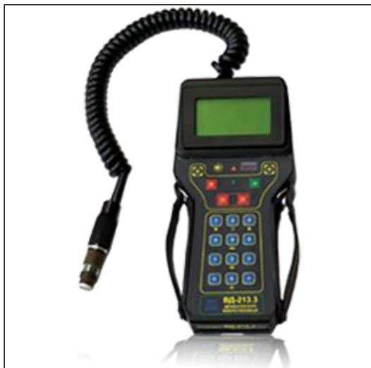
Предназначен для выявления поверхностных дефектов в деталях из ферромагнитных и цветных металлов.
