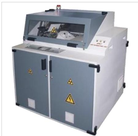
Специализированный волнодисперсионный анализатор, построенный по схеме Кошуа, предназначен для проведения высокоточного количественного определения U, Th, Mo, Au, W, Tl, As, Pb, а также других элементов в рудах, горных породах и при разработках техногенных месторождений.
