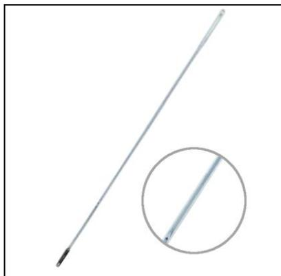
ТР-2 термометр лабораторный равноделенный позволяет с высокой степенью точности определить температуру в лабораторных условиях. Термометр может использоваться в качестве образцового.
