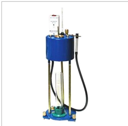
Вискозиметр для контроля качества дорожно-строительных работ. ВУБ-1Ф используется для определения условной жидких нефтяных битумов по ГОСТ 55421-13.
