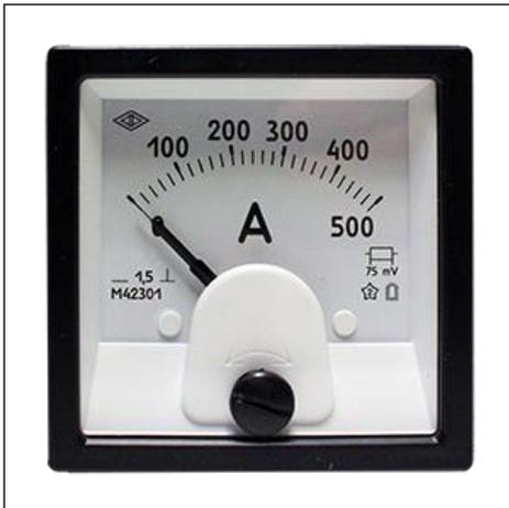
Амперметры и вольтметры постоянного тока и напряжения M42300, M42301, M42303, M42304, M42305, M42306, M4264M, M4265M предназначены для измерения токов в пределах от 10  $\mu$ A до 20 A и напряжений от 25 мВ до 750 В при непосредственном включении в цепях постоянного тока.
