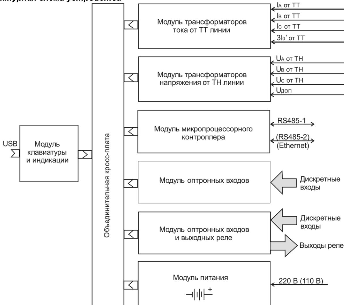
В блоке расположены модули, в состав которых входят печатная плата и другие необходимые элементы. Модули объединены между собой с помощью печатной кросс-платы. Внешние сигналы всех модулей (кроме модуля клавиатуры и индикации) выведены на заднюю панель блока и подключены к клеммам. Клеммы выполнены разъемными (целой группой), что позволяет при необходимости оперативно заменить устройство, не нарушая монтаж подводящих проводов.
