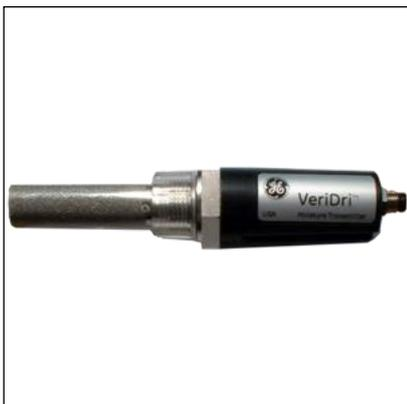
Измерительный преобразователь влажности с питанием по токовой петле и выходным сигналом 4–20 мА имеет целый ряд поддиапазонов измерения влажности, устанавливаемых на заводе-изготовителе, при общих пределах измерения от –110 до 40°С по температуре точки росы. Также он может использоваться в диапазонах влажности от 0 до 10000 PPMv в случае работы при постоянном давлении.
