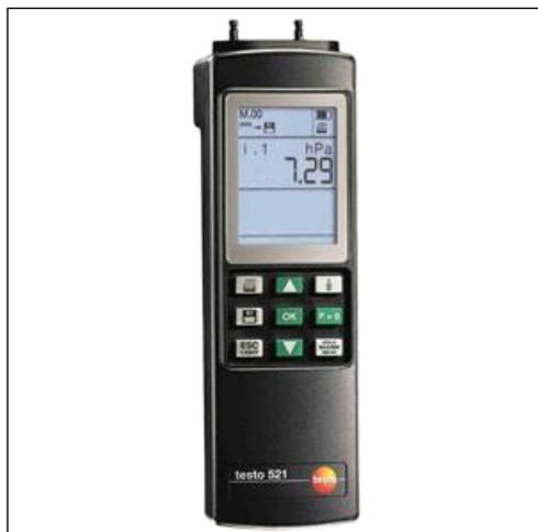
Дифференциальный манометр Testo 521-1 предназначен для измерений скорости потока от 5 до 100 м/с. Имеет погрешность 0.2 % от полной шкалы.
