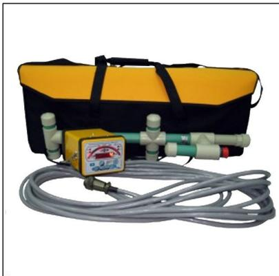
Трассопоисковый приемник многочастотный **ТМ-8П** (трассоискатель) служит для определения положения и глубины залегания подводных (подземных) металлических трубопроводов и кабелей. Приемник может использоваться как совместно с генератором ТГ-ХХ, так и автономно - для обнаружения коммуникаций в пассивном режиме.
