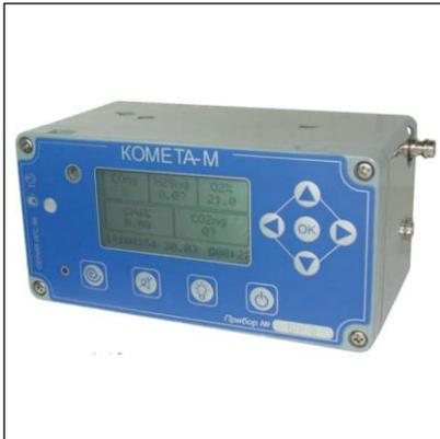
Многокомпонентный переносной газоанализатор «КОМЕТА-М» предназначен для непрерывного автоматического измерения и регистрации показаний содержания кислорода, токсичных газов и горючих.
