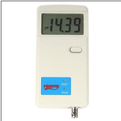
рН-метр предназначен для измерения уровня рН - концентрации свободных ионов водорода на поверхности полутвёрдых сред.
