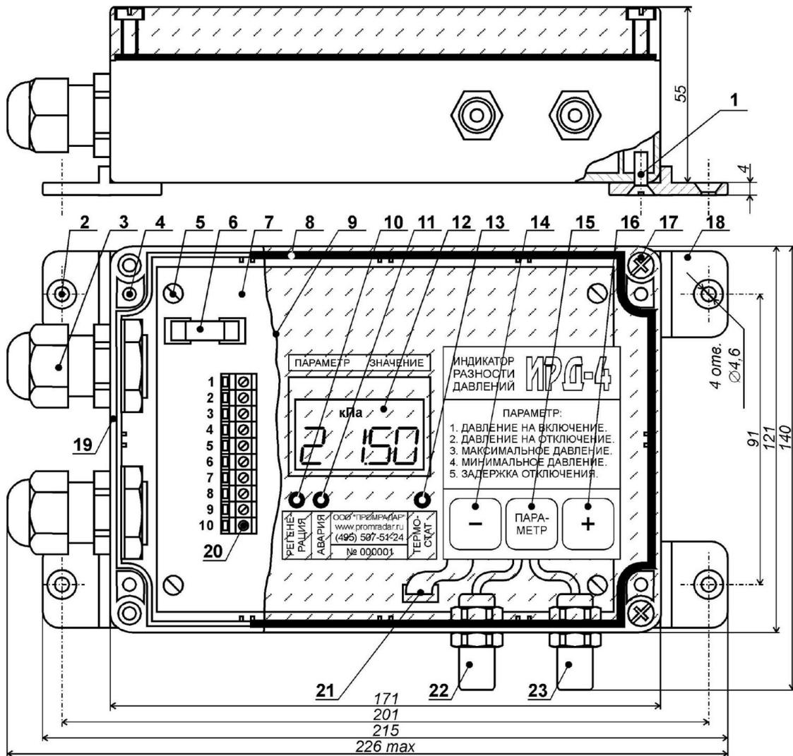
Электрическая схема прибора собрана на печатной плате [поз. 7], которая саморезами [поз.5] закреплена в корпусе [поз. 19].
