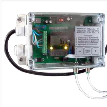
Индикатор разности давлений ИРД-4 предназначен для контроля уровня запылённости промышленных воздушных фильтров и выдачи электрического сигнала на управление их регенерацией (очисткой от пыли).
