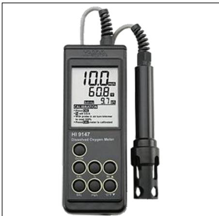
Предназначен для определения растворенного кислорода и температуры в воде и растворах для контроля за качеством воды в процессах водоочистки, в рыбопродуктивных хозяйствах, экологических исследованиях, бассейнах и т. д.
