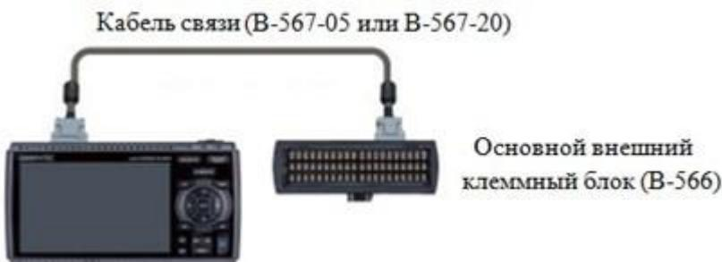
3. Блоки и панели фиксируются защелками на подключенном клеммном блоке В-566.
