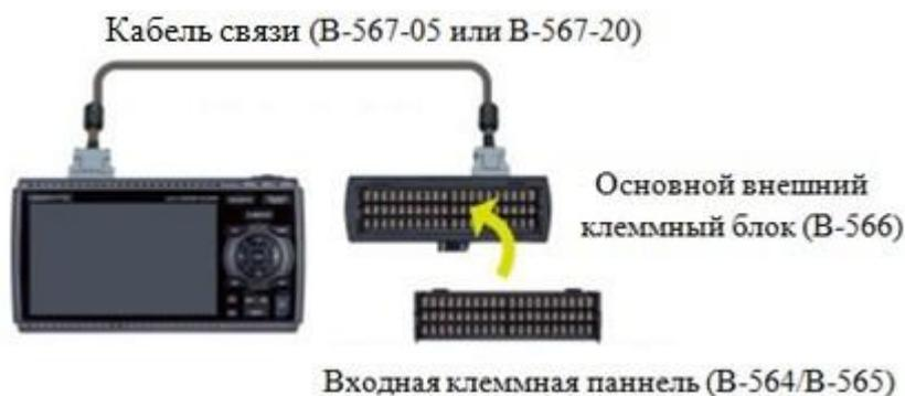
4. Клеммный блок В-566 соединяется в гирляндную цепь добавлением клеммного блока (В-564 или В-565).
