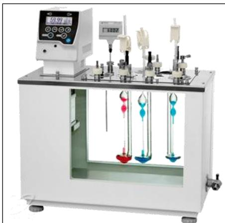
Жидкостный переливной термостат с прозрачными стенками ВИС-Т-07 предназначен для поддержания заданной температуры при проведении измерений вязкости нефтепродуктов с помощью стеклянных вискозиметров в соответствии с ГОСТ 33, ГОСТ Р 53708, ASTM D445, IP 71, ISO 3104 и DIN 51366.
