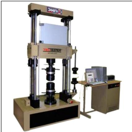
Разрывная машина универсального назначения ИР-5145-500 с электронным силоизмерителем предназначена для испытания образцов материалов и изделий (труб и др.) на растяжение, сжатие и изгиб на 500кН. Устанавливается на фундаменте.
