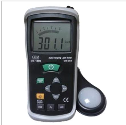
Прибор DT-1309 предназначен для измерения уровня освещения в диапазоне 0... 400000 Lux.
