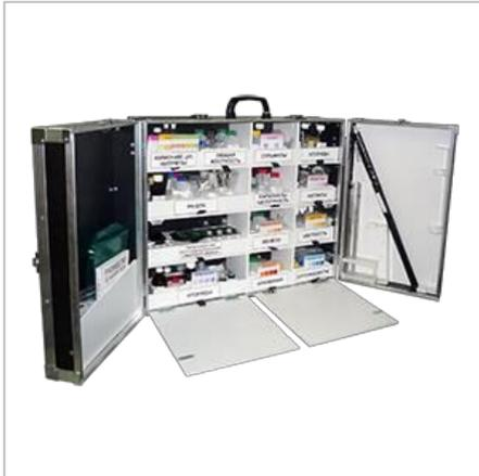
Настольная лаборатория анализа воды модели НКВ-12П (базовая модификация с приборами) предназначена для анализа питьевой и природной воды (воды водоёмов хозяйственно-бытового, культурно-бытового назначения, поверхностных водоисточников и т.п.) по 21 важнейшему показателю.
