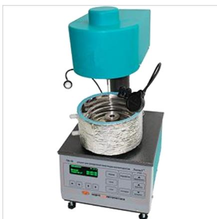
Автоматический аппарат ПН-10ГР ЛинтеЛ предназначен для определения упругости герметиков горячего нанесения. ПН-10ГР соответствует стандартам EN 13880-3, ASTM D 5329.
