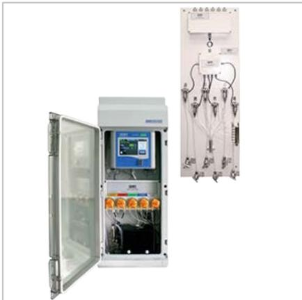
Анализатор МАРК-1202 предназначен для высокоточных измерений диоксида кремния в технологических водах и парах тепловых и атомных электростанций, а также используется для контроля процессов водоподготовки в различных отраслях промышленности. В основу работы прибора заложен фотометрический способ измерения с автоматическим дозированием реагентов.
