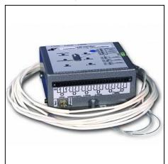
Устройство с волоконно-оптическим датчиком предназначено для фиксации момента возникновения дуги в шкафах комплектных распределительных устройств (КРУ) 6–35 кВ и выдачи сигнала управления в цепи автоматики и релейной защиты. Устройство может быть использовано как совместно с устройствами микропроцессорной релейной защиты типа «Сириус», «Орион», с устройствами других фирмизготовителей, так и с любыми другими видами защит, например, на электромеханической элементной базе.
